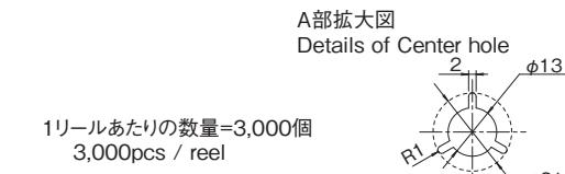
KMS ヒューズ テーピング寸法図 Tape for fuses, type KMS
